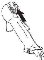
**ВНИМАНИЕ!** Изключвателят автоматично се връща на първоначалното си положение. За да предотвратите неумишлено запалване капачката на свещта трябва да бъде отстранена от свещта при монтиране, проверка и/или провеждане на техническа поддръжка.
