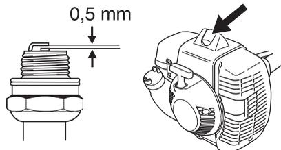
**ВНИМАНИЕ!** Използвайте винаги запалителните свещи от препоръчания вид! Използуването на погрешен тип свещи може да предизвика сериозни повреди на буталото/цилиндъра.
