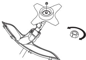
Найлоновото застопоряване на контрагайката не бива да бъде износено до степен, че да може да се върти с пръсти. Застопоряването трябва да издържа поне на усилие равно на 1,5 Нм. Гайката трябва да се смени след като е завинтана около 10 пъти.
