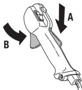
Уверете се, че регулаторът на дроселната клапа е в положение на празен ход, когато фиксаторът на дроселната клапа се намира в изходното си положение.
