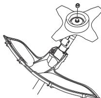
При монтирането гайката следва да се затяга в обратната посока на въртенето на ренжестото оборудване. При демонтиране гайката следва да се отвинтва по посока на въртенето на ренжестото оборудване. (ЗАБЕЛЕЖКА! Гайката
