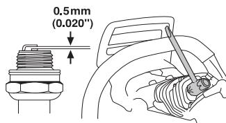
**ЗАБЕЛЕЖКА!** Използвайте винаги запалителните свещи от препоръчания вид! Използването на погрешен тип свещи може да предизвика сериозни повреди на буталото/цилиндъра. Убедете се, че запалителната свещ е снабдена със защита от радиосмущения.
