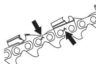
Пропорчваме ви да извършвате сравнение с нова верига, за да определите степента на износване.
