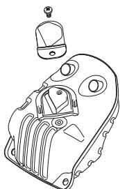
Ауспухът е предназначен за намаляване равнището на шума и насочване на отработените газове встрани от оператора. Отработените газове са нагрети и могат да
