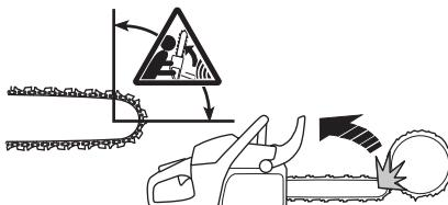
Обратният тласък е винаги в посока на шината. Обикновено верижният трион и шината се отхвърлят назад и нагоре, по посока на оператора. Но верижният трион може да отскочи и в други посоки в зависимост от положението си в момента, когато рисковият сектор на шината се допре до някакъв предмет.
