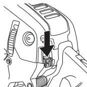
**ЗАБЕЛЕЖКА!** Ключът за пускане и спиране автоматично се връща на работно положение. За да се избегне непреднамерено стартиране, капачката на запалителната свещ трябва да се свали от свещта при монтаж, проверка и/или изпълняване на техническо обслужване и поддръжка.
