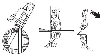
Повалящият срез трябва да завърши успоредно на линията на направляващия срез, като разстоянието помежду им трябва да бъде най-малко 1/10 от диаметъра на стъблото. Несрязаната част на дървото се нарича предпазна ивица.
