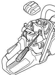
За температури под -5° и/или при снеговалеж е предвиден специален капак, който се монтира на корпуса на стартера.
