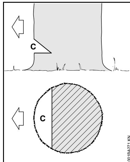
Засекът (C) определя посоката на поваляне
