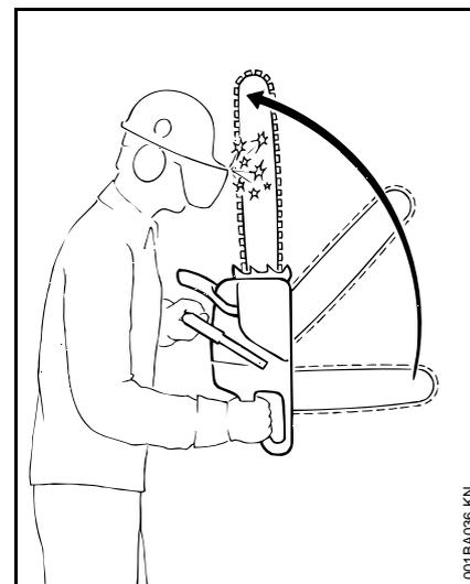
При обратен удар ("кик-бек") трионът отскача внезапно и неконтролируемо към работещия с него.
