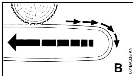
Когато при рязане с горната част на направляващата шина – заден врез – режещата верига се заклеци или опре на твърда повърхност в дървото, моторният трион може да занесе /скочи в посока на работещия с него – **за да избегнете това:**
