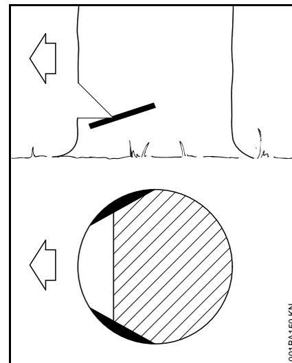
При дървета с надлъжен фазер – нарезите предотвратяват разцепване на ствола при повалянето на дървото – те се нарязват от двете страни на ствола на височината на основата на засека на приблизително 1/10 от диаметъра на дървото, а при подебели дървета – на дълбочина най-много равна на широчината на шината.
