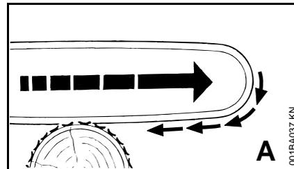
Когато при рязане с долната част на направляващата шина – преден врез – режещата верига се заклеши или опре на твърда повърхност в дървото, моторният трион може да занесе /скочи рязко в посока към ствола на дървото – **за да избегнете това, винаги забивайте здраво зъбната опора.**
