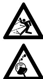
Проверете терена за работа: твърди предмети – като камъни, метални части и други подобни, могат да отхвърчат от ускорението на машината – също и на по-далече от 15 m – **опасност от нараняване!** – и могат да повредят както режещия инструмент, така и други предмети в близост – като например паркирани автомобили, стъкла на прозорци (нанасяне щети на имущество).
